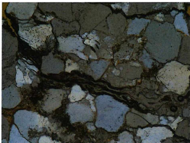
Figuur 7: slijpplaatje cilinder I scheuren in kwartskorrel met asr gel (100X PPL)
