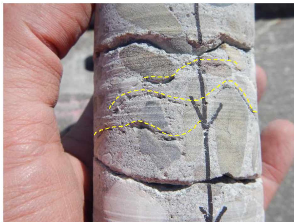
Figuur 6: Meerdere scheuren nog in ontwikkeling tussen de twee grotere scheuren
