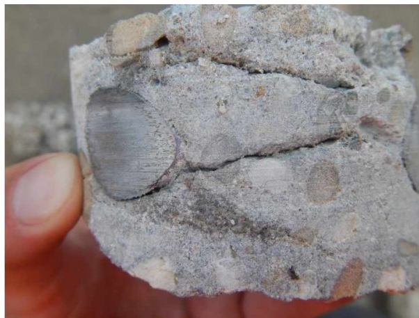
Figuur 8: ASR kern I scheurontwikkeling rond wapening
