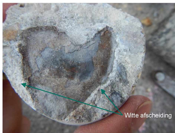
Figuur 4: Afscheiding van gel op rand van gebroken kiezel
