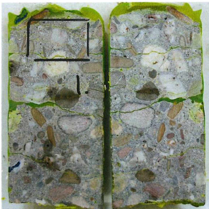
Figuur 33: Doorgeslepen ASR kern I in epoxy
