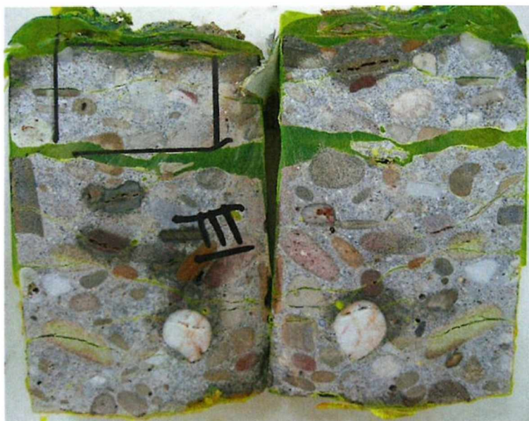
Figuur 35: Doorgeslepen ASR kern III in epoxy
