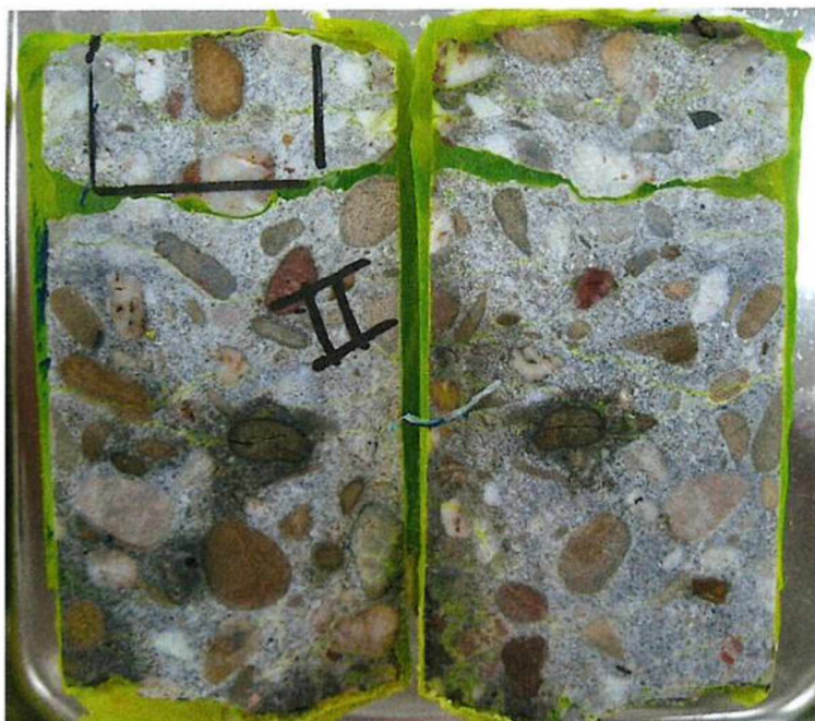
Figuur 34: Doorgeslepen ASR kern II in epoxy
